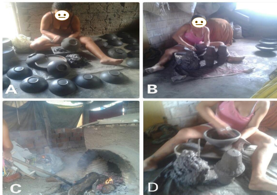
Figura 2 (A,B,C, D): Demonstração do processo produtivo (SANTOS, 2018).
