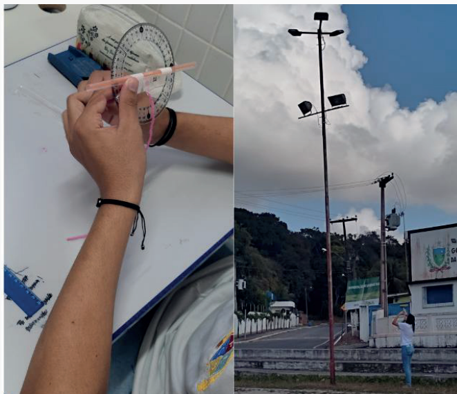
Figura 10 - Construção do teodolito e sua utilização
