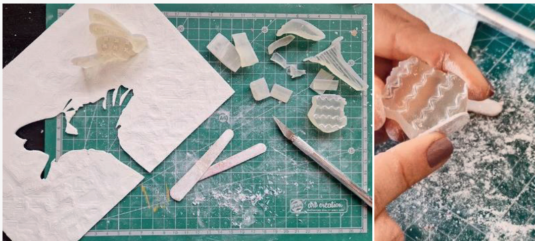
Figuras 06: Processo manual para lixar e ajustar as peças de resina na placa.
