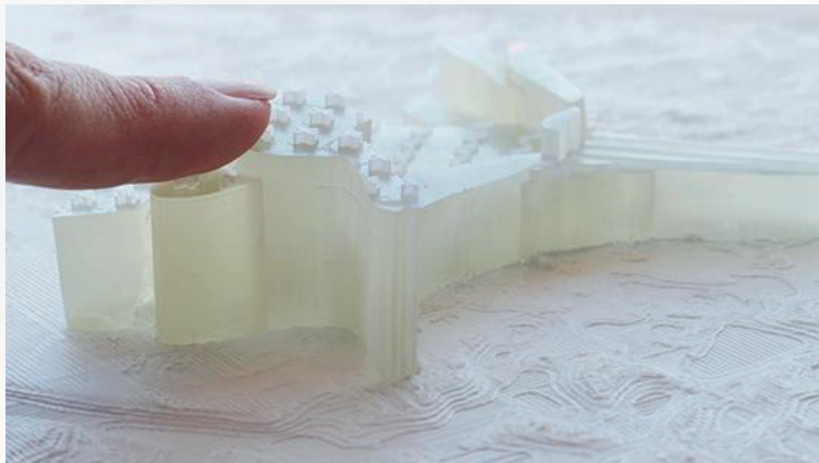
Figura 07: Peças impressas em resina que apresentam diferentes texturas por meio do uso de padrões geométricos, como também diferentes alturas.
