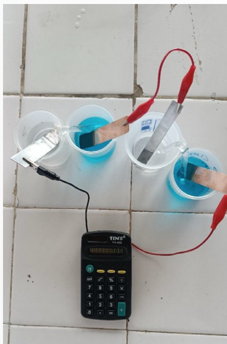
Figura 6. Montagem de pilhas eletroquímicas em série para acionamento de calculadora.
