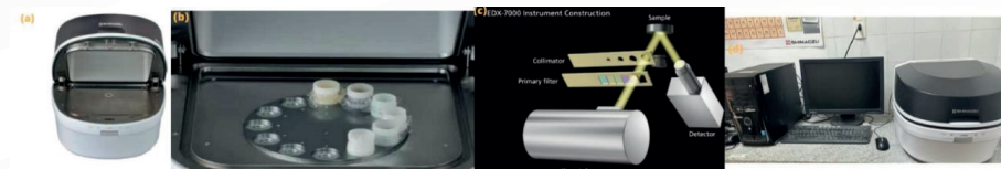
Figura 4: (a)-(b) Imagem do Espectrômetro de Fluorescência de Raios X da Shimadzu, EDX – 7000 com a câmara de amostras aberta, onde sob o prato móvel de amostras, fica embutido o sistema óptico (c), (d) EFRX do CSAMA/UERN.
