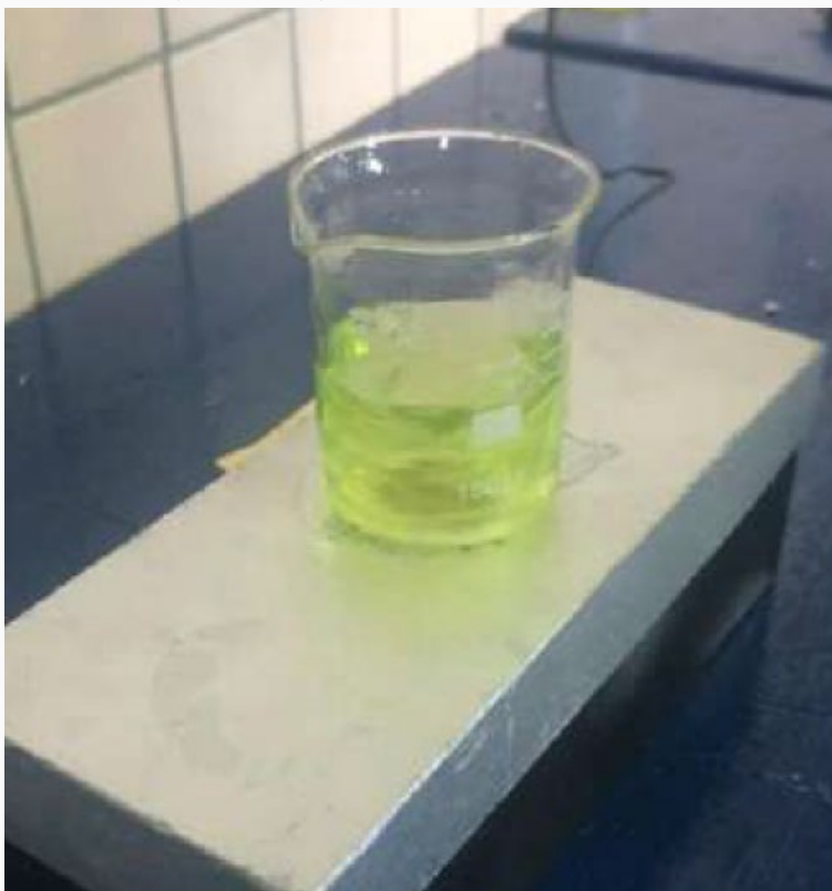
Figura 3a. Agitador magnético confeccionado pelos estudantes.
