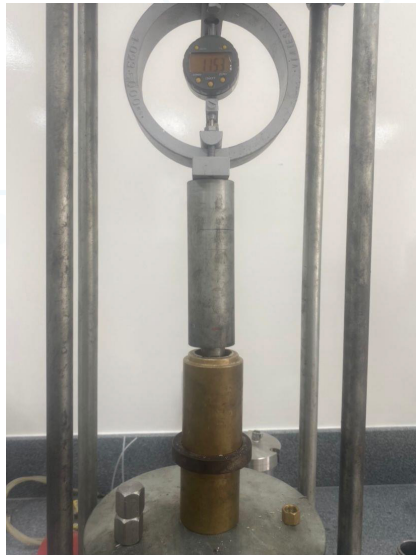
Figura 12 – Prensa CBR para compactação da amostra
