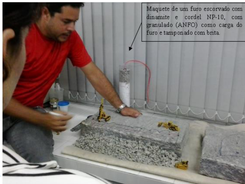
Figura 6. Colocação dos fios simulando o cordel detonante.
