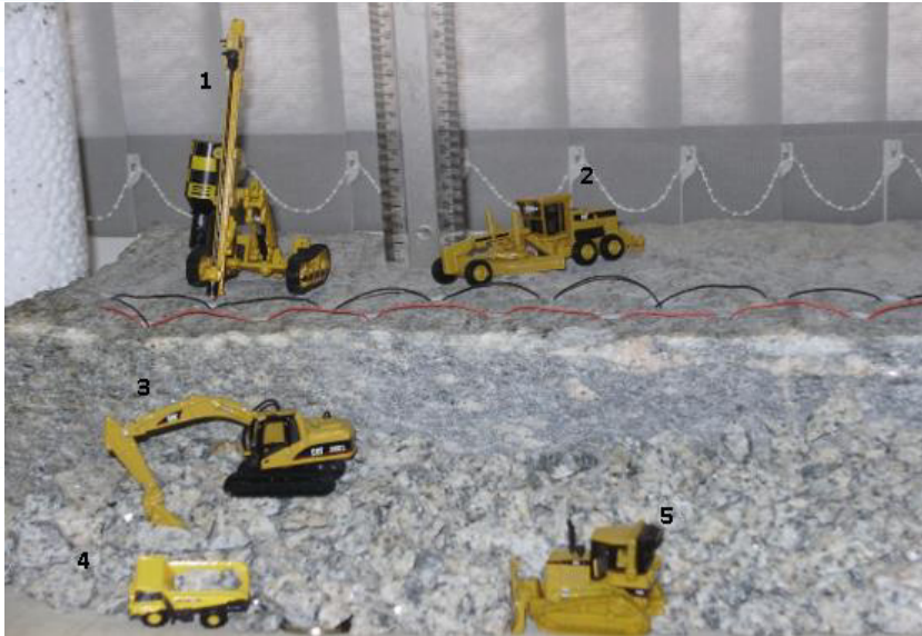
Figura 9. Maquete simulando uma operação de exploração, onde: 1-Perfuratriz, 2-Moto niveladora, 3-Escavadeira, 4-Caminhão fora de estrada e 5-Trator de esteira
