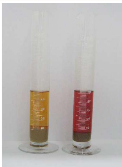
Figura 3 – Inchamento de Foster com os solventes gasolina (esquerda) e diesel (direita).
