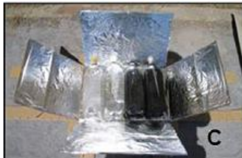
Figura 4: Reator de Pet para tratamento de água
