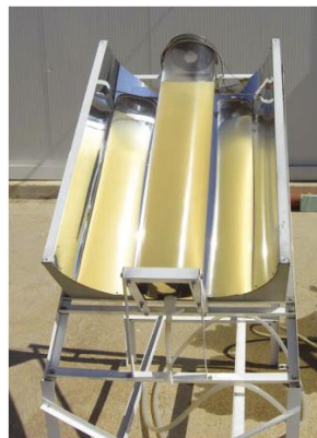
Figura 5: Reator de Polimetil-metacrilato para tratamento de água
