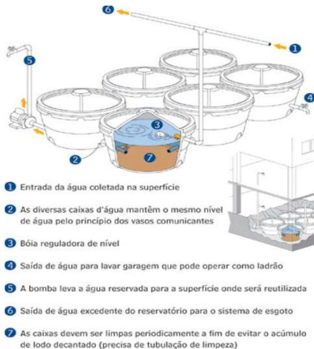
**Figura 2.** Esquema de captação e armazenamento de água de chuva.
