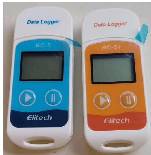
Figura 1 - Dataloggers utilizados no monitoramento da temperatura nos pontos estudados
