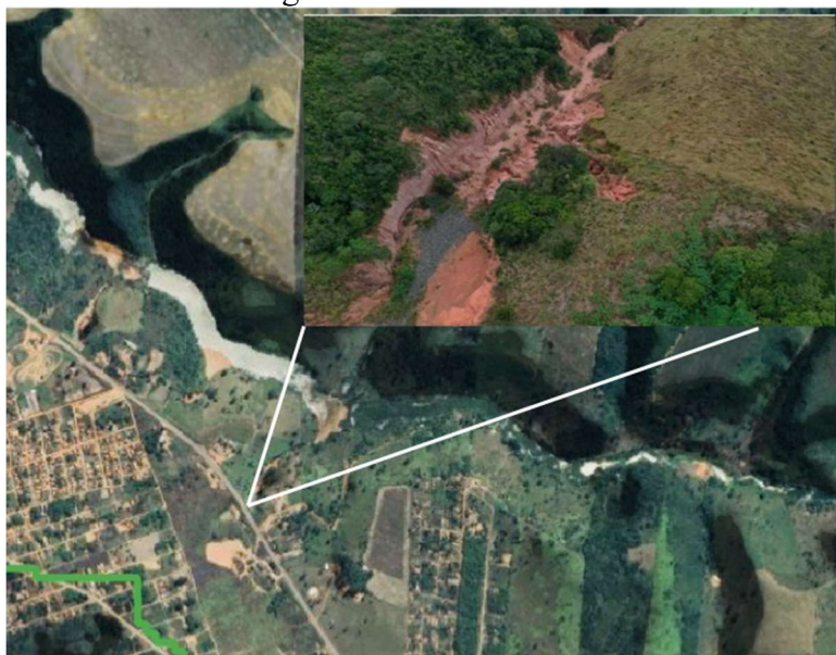
Figura 7 - Na figura evidencia-se o avançado processo erosivo da EV-02 (Erosão-Voçoroca) na borda do platô. A erosão encontra-se na face oriental da microbacia hidrográfica do rio Buritizinho.
