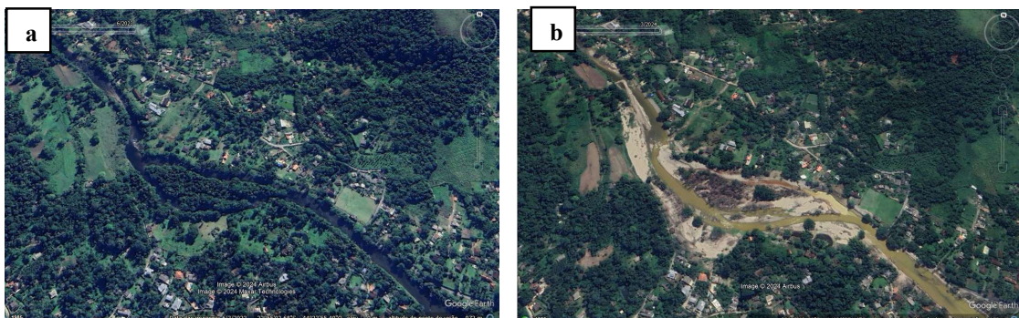
Figura 3. Ilha fluvial e margens, (a) antes e (b) após evento, com árvores arrancadas, forte assoreamento, deposição e alteração na coloração da água do rio Bracuí, Angra dos Reis (RJ).
