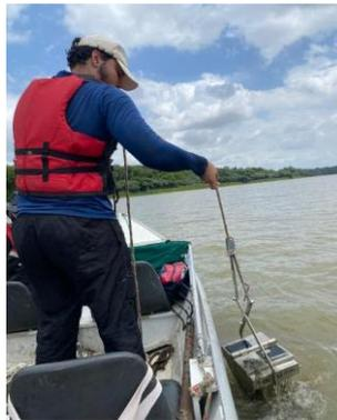
*Figura 2: Coleta de sedimento superficial no Lago Água Preta utilizando uma draga de Van Veen, que captura sedimentos até 10 cm de profundidade. Amostras de aproximadamente 500 g foram obtidas para análises granulométricas e de matéria orgânica.*
