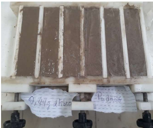
(a) moldes com argamassa aplicada
