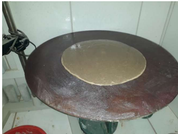
Figura 3 – Consistência da argamassa após o ensaio
