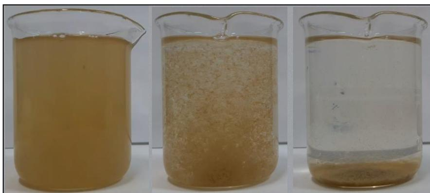
**Figura 3** – Efeito da coagulação e floculação na amostra de água turva de 400 NTU após adição de melhor concentração do coagulante e do alcalinizante (0,65 e 0,46 g L<sup>-1</sup> de extrato e Ca(OH)<sub>2</sub> respectivamente), sob 2 minutos de mistura e 30 min para sedimentação.
