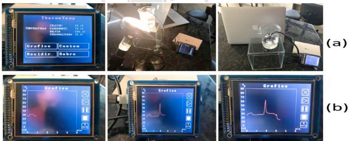
Figura 7. (a) Teste experimental do medidor. (b) Evolução gráfica em tempo real.
