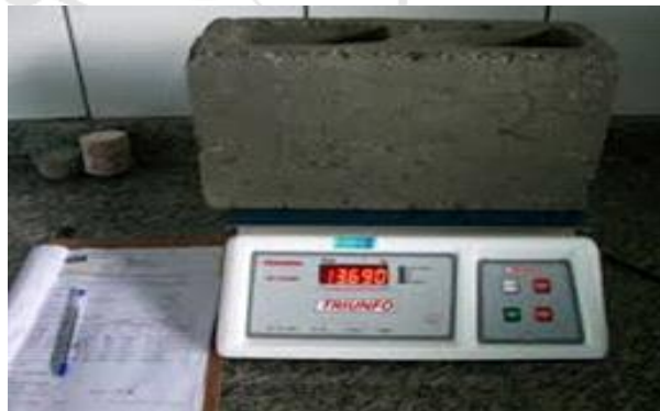
Figura 4: Determinação do peso específico de blocos de concreto.
