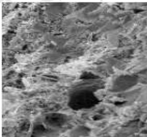
**Figura 5** – Micrografias do concreto com 20% de substituição do cimento Portland por resíduo de petróleo em pó.
