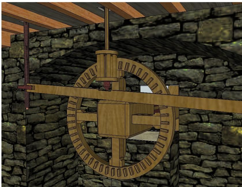
**Figura 1- Modelo de azenha de copos onde é perceptível a ligação entre a entrosga e os fúeis do carroto**
