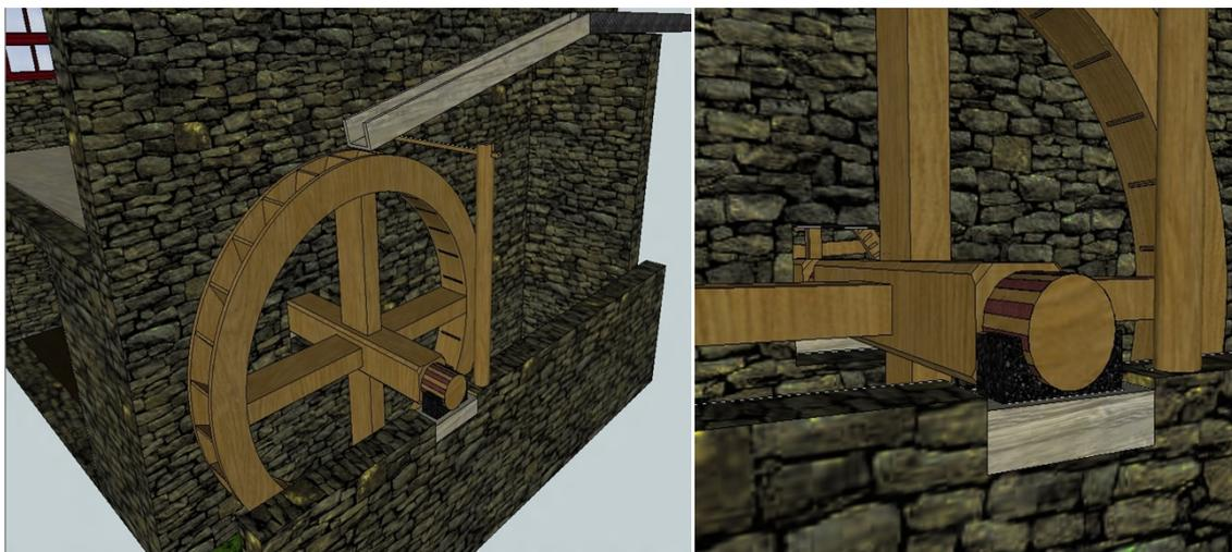
**Figura 2- Sistemas de transferência de energia cinética e potencial da água em energia cinética da roda da azenha.**
