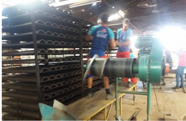
Figura 02 – Organização das peças pré-moldadas
