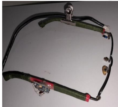
Figura A: Vista Lateral do Colibrino- óculos com sensor infravermelho acima e sensor giroscópio abaixo
