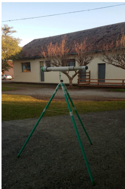
Figura 1: Telescópio com materiais de baixo custo em funcionamento
