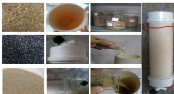
Figura 1 – Construção e instrumentação do filtro alternativo em escala piloto.
