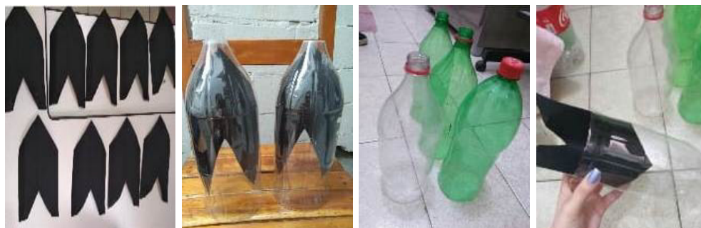
Figura 2. Etapas de montagem do aquecedor solar
