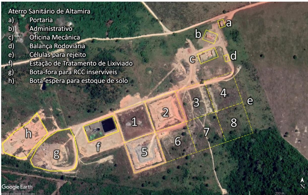
Figura 3: Estrutura de funcionamento do Aterro Sanitário de Altamira-PA
