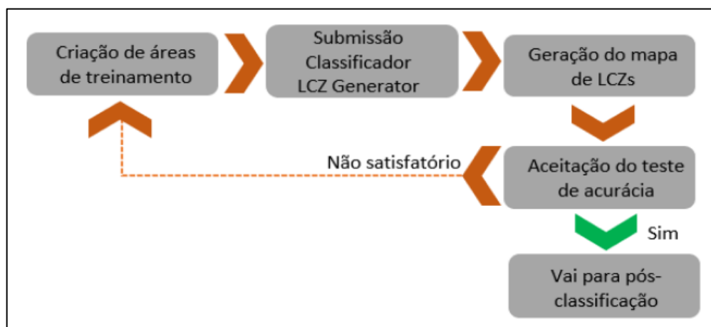
Fluxograma 1 – Etapas da utilização do LCZ Generator
