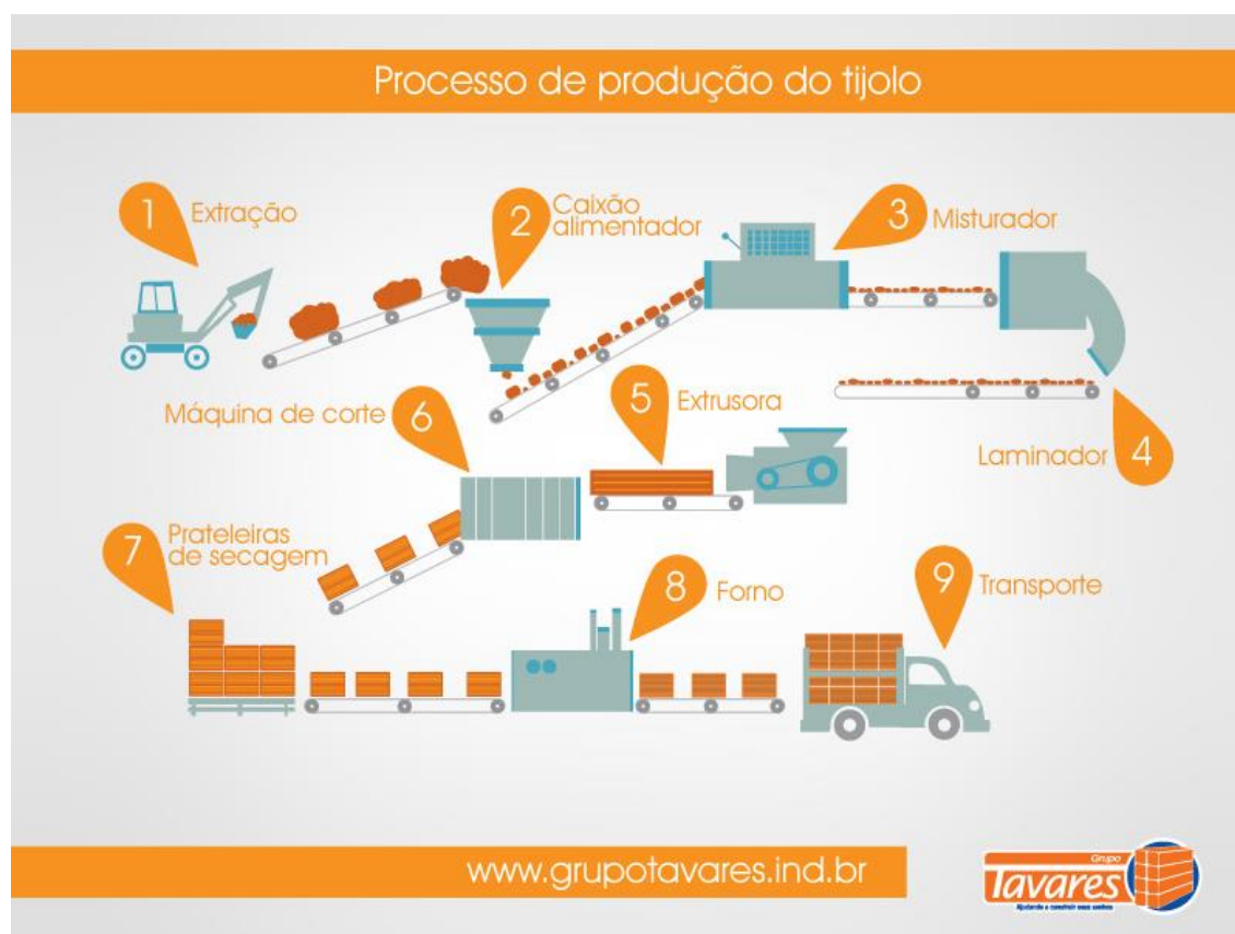
Figura 4 – Ilustração do processo produtivo de cerâmica vermelha.
