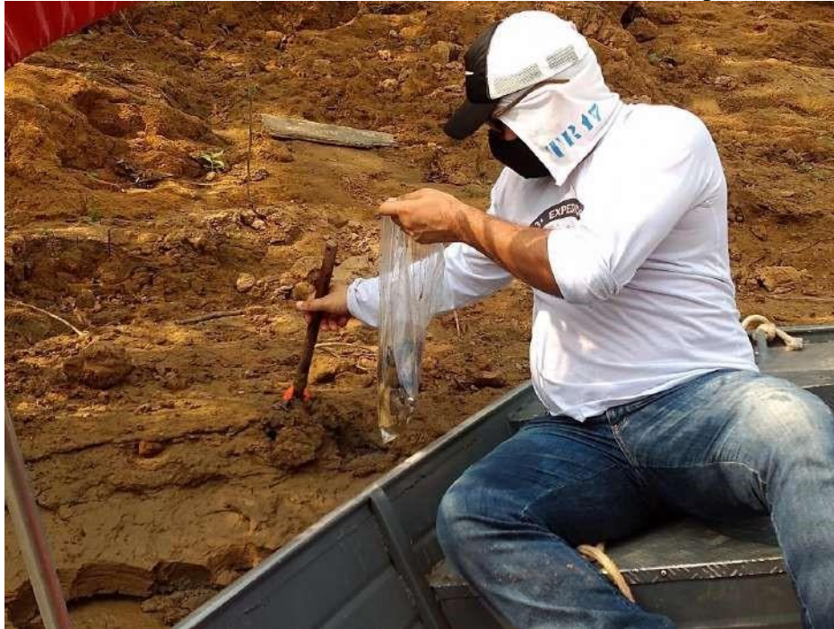
Figura 4. Coleta de Sedimentos de fundo e armazenamento em sacos plásticos de 5 kg.
