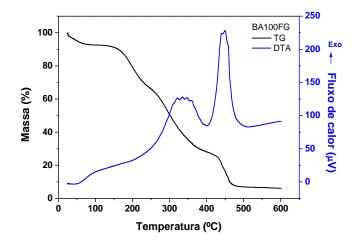
O briquete constituído por 100% de casca de arroz aglutinado com glicerina (BA100FG – Figura 8) apresenta três estágios de decomposição térmica iniciados em iniciados em 84,5; 223,2 e 368 °C, com perdas de massa correspondentes a 28,4; 40 e 24,3 %, resultando em 7,3 % de resíduo. As perdas de massas são atribuídas à umidade, seguida da decomposição da hemicelulose, celulose e lignina presente na amostra, resultando o resíduo inorgânico
