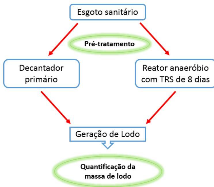
Para produção de lodo primário, foram efetuados ensaios de sedimentação, semanalmente. Houve a coleta de 12 litros de esgoto sanitário, e após 1 hora, adensado para um volume de 1L. Desse volume, o sobrenadante foi retirado e o material sedimentado foi recolhido, obtendo-se o lodo primário (LP) utilizado para análises físico-químicas de caracterização.
