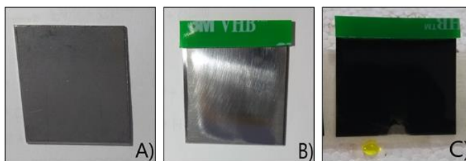
Figura 2. Metodologia da construção de batente: (A) Substrato antes do tratamento mecânico; (B) Após tratamento mecânico e com batente; (C) Substrato eletrodepositado com batente.
