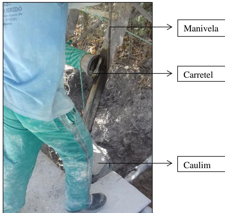
Figura 5. Subida do caulim em balde de borracha no garimpo, do município de Equador/RN. Fonte : arquivo pessoal
