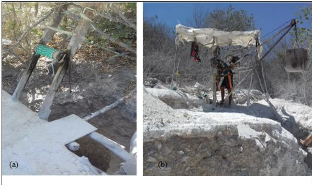
Figura 1. a) Equipamento manual, com carretel e cordas para içamento de material; b) Extração semi-mecanizada com motor movido a óleo diesel e çambas para remoção do minério. Fonte: arquivo pessoal
