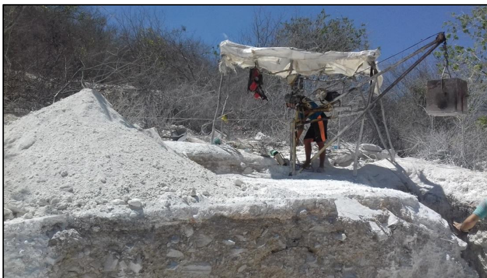
Figura 3. Operação mecanizada da extração de caulim em Galo Branco, Equador/RN. Fonte: arquivo pessoal
