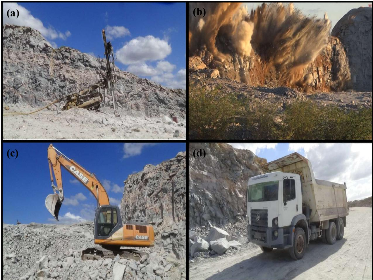
**Figura 3:** Perfuração dos furos com perfuratriz pneumática (a); desmonte de rocha utilizando substância explosiva (b); retroescavadeira CASE realizando o trabalho de carregamento do material desmontado (c); caminhão basculante utilizado para transporte do minério para o britador (d).
