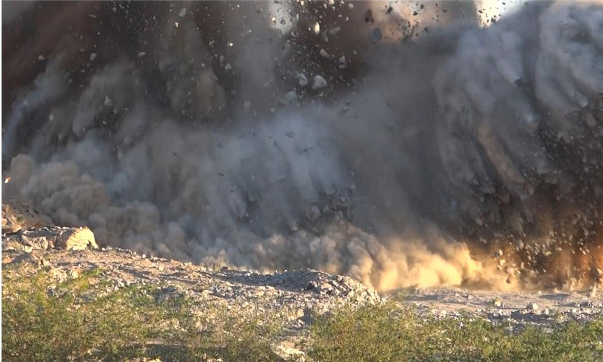
**Figura 4:** Ultralançamentos de fragmentos de rochas oriundos da detonação.
