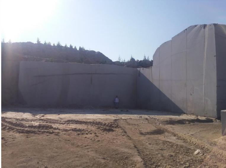
**Figura 4 - Bancada de extração da rocha.**
