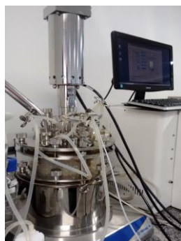
Figura 1 - Processo de fermentação em biorreator.
