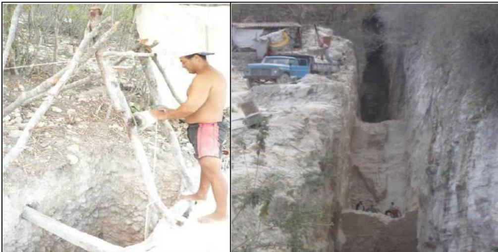
**Figura 3 – Formas de realização de escavações para extração de caulim, a esquerda um poço vertical utilizado para acesso ao veio mineralizado (Fonte: Almeida, 2010). Mais a direita, escavação a céu aberto para extração de caulim (Fonte: Silva, 2011).**
