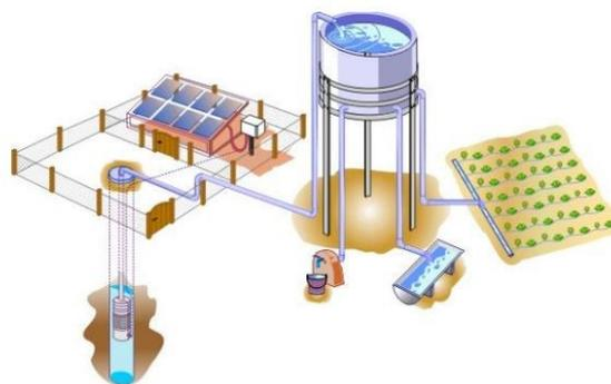
**Figura 3** – Sistema fotovoltaico de bombeamento para consumo humano e irrigação
