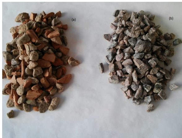
Figura 2. Agregado graúdo RCD, D_{m\acute{a}x} de 19 mm (a), agregado graúdo de rocha granítica, D_{m\acute{a}x} de 19 mm (b).
