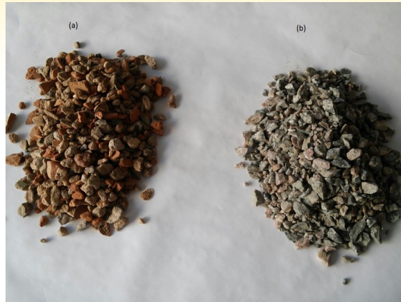
Figura 1. Agregado graúdo RCD, D_{m\acute{a}x} de 12 mm (a), agregado graúdo de rocha granítica, D_{m\acute{a}x} de 12 mm (b).
