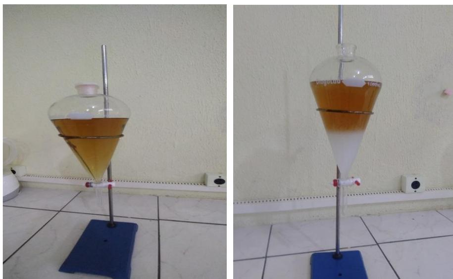
**FIGURA 2.** Biodiesel antes e depois da separação de fases.
