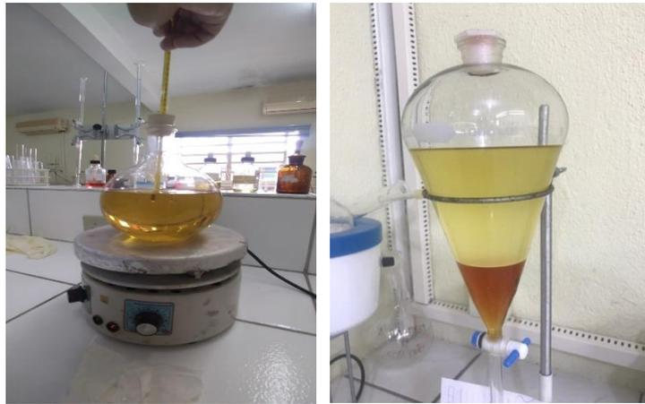
**Figura 1.** Processo de produção do éster (biodiesel).
