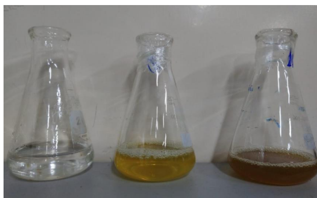
Figura 6. Da esquerda para a direita: microemulsão livre de óleo pré-extração, microemulsão após o primeiro ensaio de extração e microemulsão após o último ensaio de extração.
