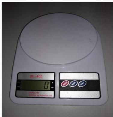
**Figura 5 – Balança SF – 400 (10.000 g x 1 kg).**
