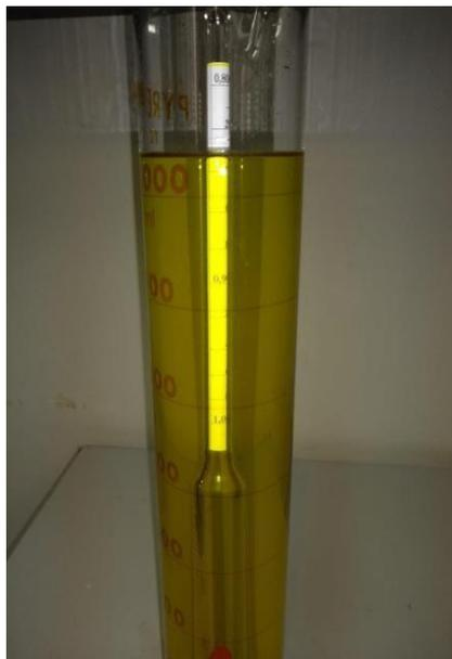
**Figura 4 – Densímetro inserido na amostra.**
