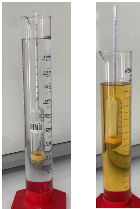
Figura 1 - Utilização do densímetro para medição da densidade do etanol e da gasolina.
