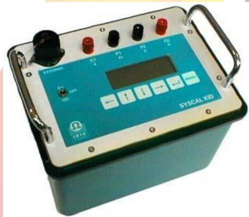
Figura 3: Eletrorresistivímetro modelo Syscal Kid.
