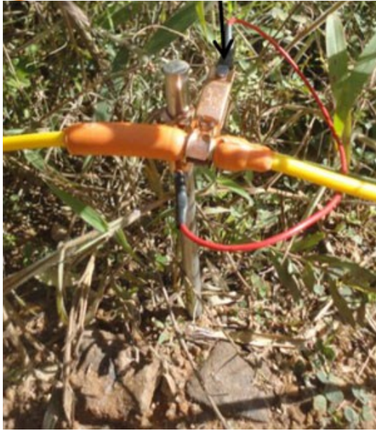
Figura 3: Detalhe do eletrodo conectado ao cabo de aquisição.
