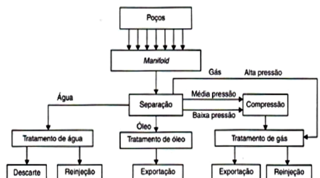
Figura 23 - Fluxograma mostrando o processamento primário de petróleo e gás.
