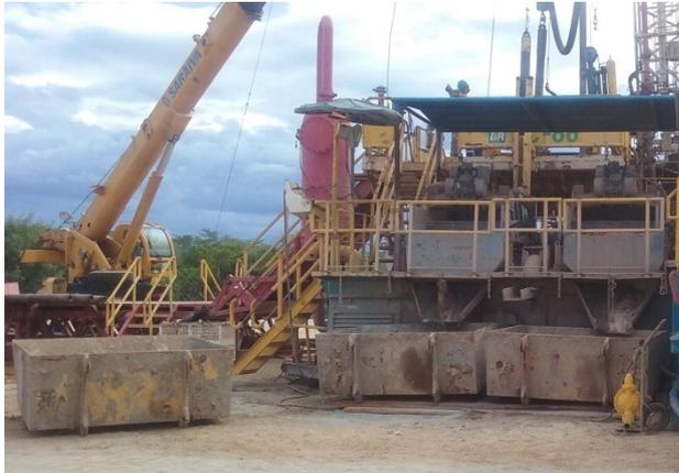
Figura 1: Sonda de perfuração – caixas de coleta de cascalho.
