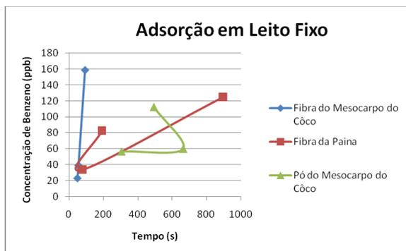
Figura 7: Remoção de benzeno através da ação dos bio sorventes em leito fixo.
