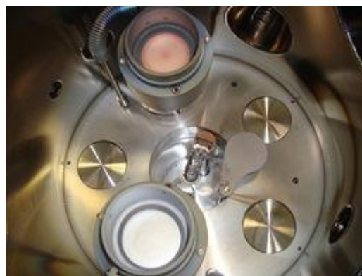
Figura 3: Interior da câmara principal
